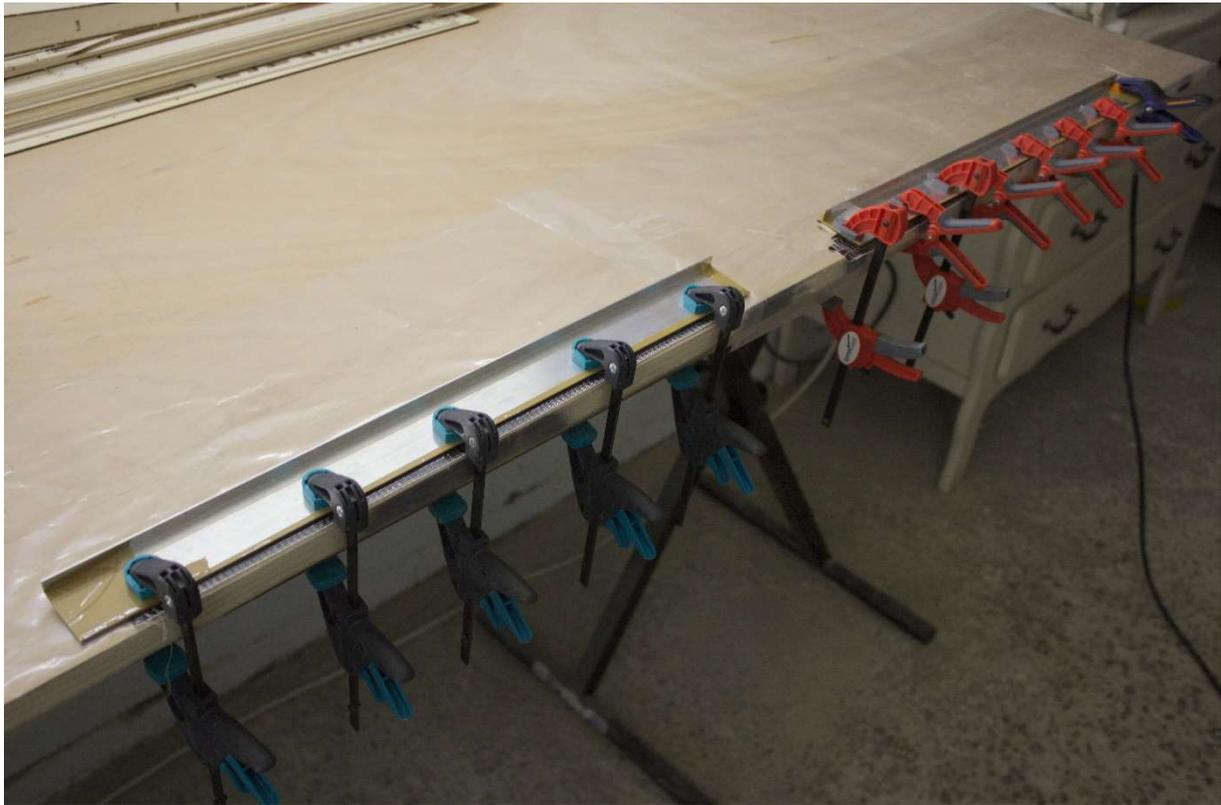
Ames balsa fibre horizontal en baguette 5x3mm ajusté et collé à la colle cyanoacrylate.
