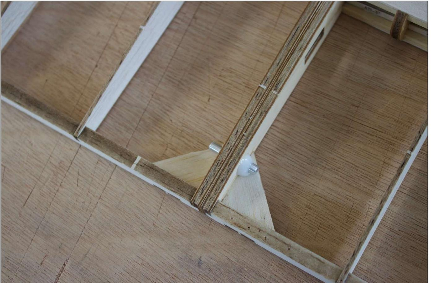
Assemblage des ailerons, suivre la même procédure que pour les volets.
